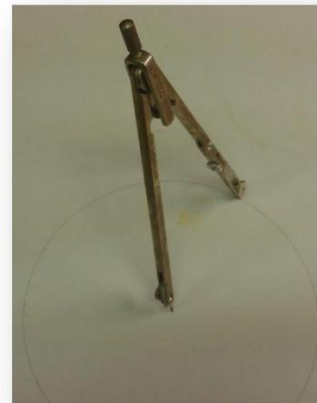
2. Zeichnen Sie mit Hilfe eines Zirkels den Durchbruch an. Bitte wählen Sie die Öffnung nur 1 mm größer, um genügend halt für die Schrauben zu gewährleisten. Bitte kontrollieren Sie vor dem Sägen, ob hinter der Durchbruchsstelle genügend Platz ist und sich keine Kabel, Versorgungsleitungen etc. befinden!
